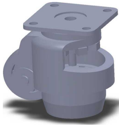
Hình 2.12: Bản vẽ bánh xe di chuyển khung máy in 3D
