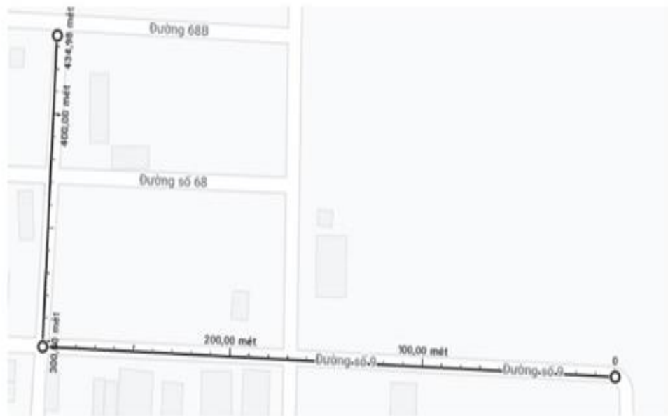
Hình 4.12: Sơ đồ có số mét cáp quang thực tế từ nhà khách hàng đến OTP
