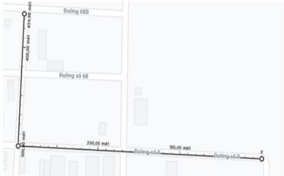
Hình 4.12: Sơ đồ có số mét cáp quang thực tế từ nhà khách hàng đến OTP
