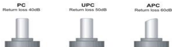
Hình 2.7: Hình ảnh điểm tiếp xúc PC, UPC và APC
