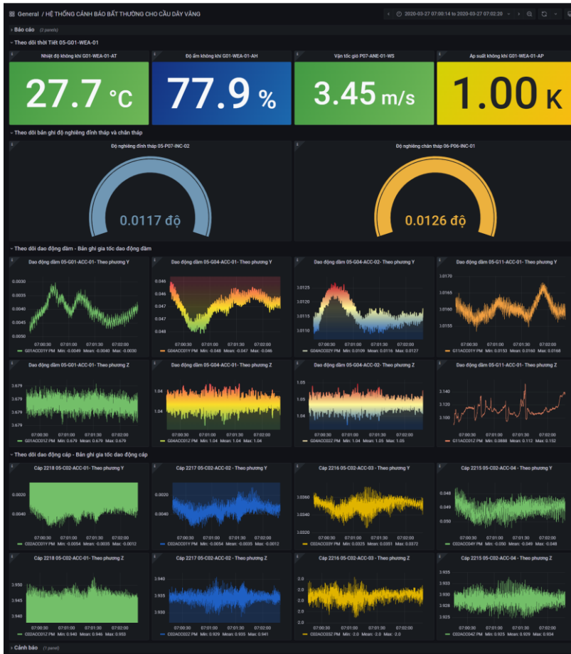
Hình 4.9: Dashboard của hệ thống giám sát cầu dây văng đã triển khai
